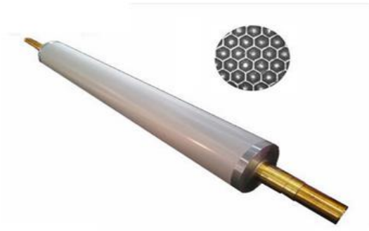
Рис. 2. Зовнішній вигляд валика та гексагоний тип комірок
